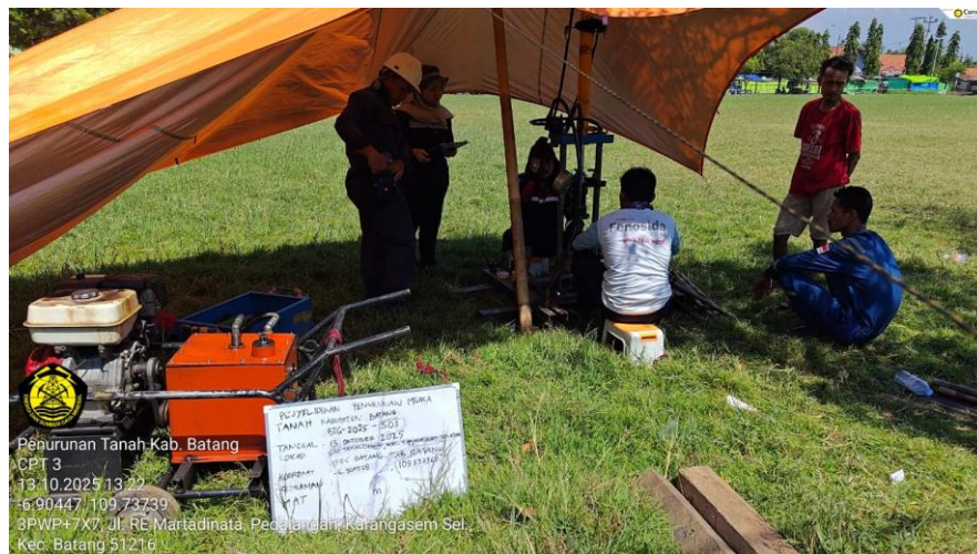
Gambar 7. Kegiatan Uji Sondir untuk Peta Penurunan Muka Tanah Kab. Batang, Prov. Jawa Tengah
